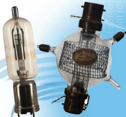
Катодное реле Тверской радиостанции конструкции лампа-бабушка
