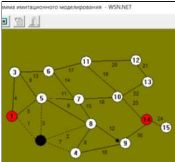
Рисунок 4.9 – Окно визуализации эксперимента на модели (спящие узлы – черные кружочки)
