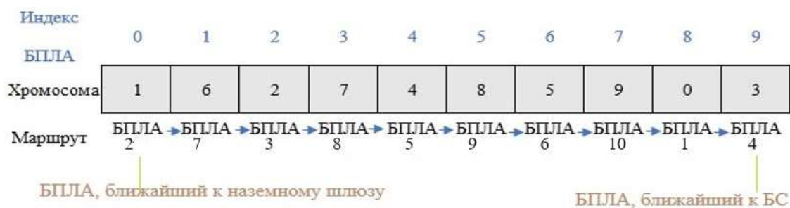
Рисунок 3.10 - Схематическое представление кратчайшего пути в хромосоме.
