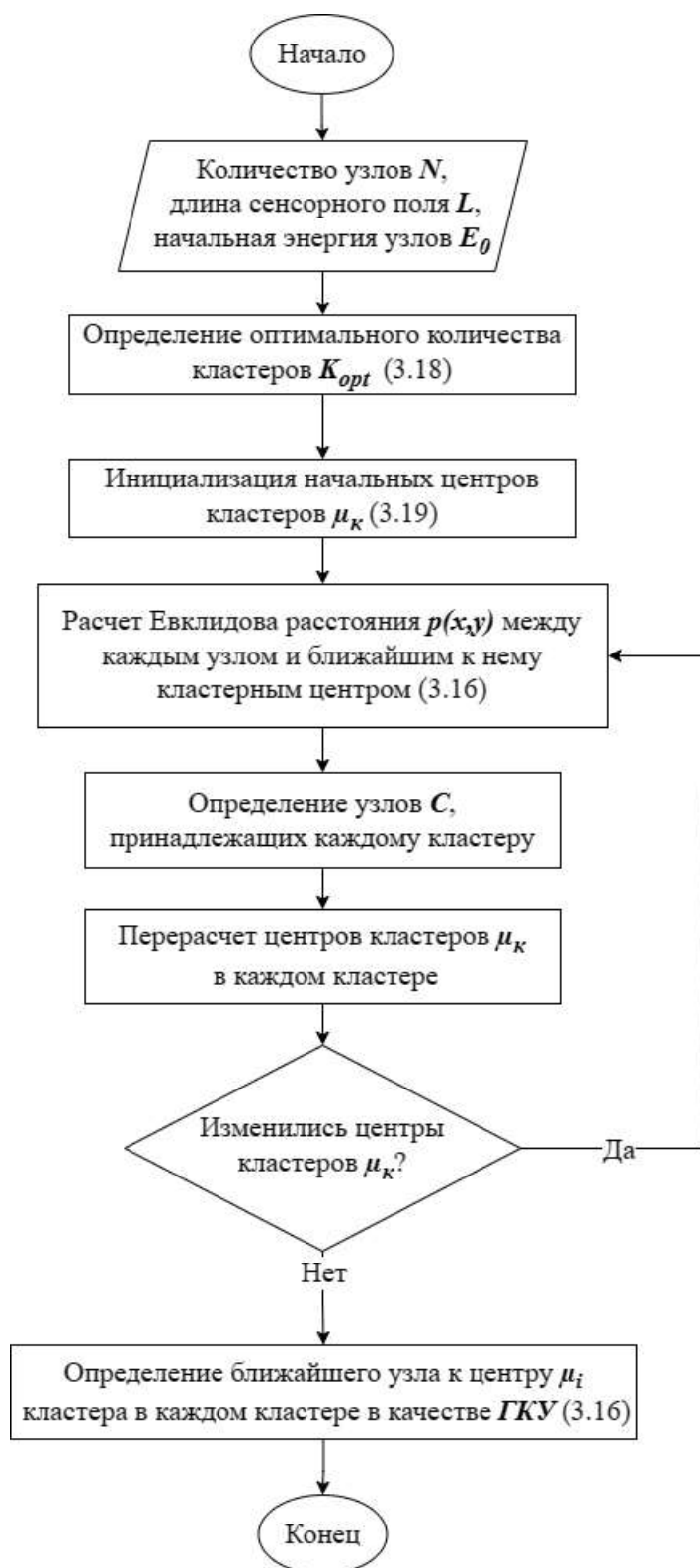
Рисунок 3.6 - Блок-схема модифицированного алгоритма К-средних
