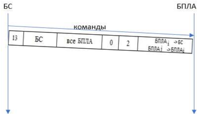
Рисунок 3.16 - Схема пакета "КОМАНДЫ" при маршрутизации в рое БПЛА
