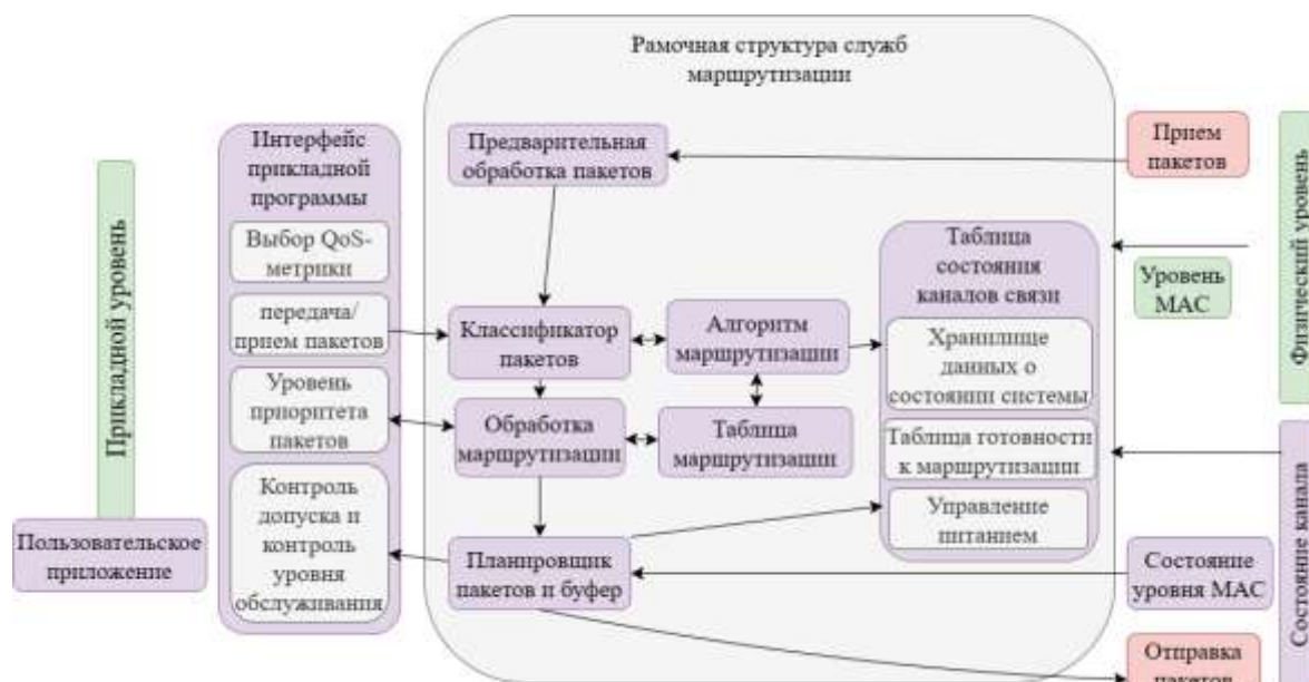
Рисунок 2.1 - Архитектура протокола маршрутизации в БСС [92]
