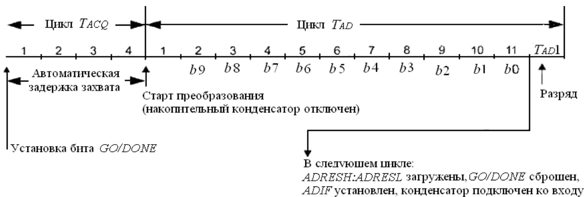
Рис. 4. Цикл преобразования ( ACQT <2:0> = 010, TACQ = 4 T_{AD} )
