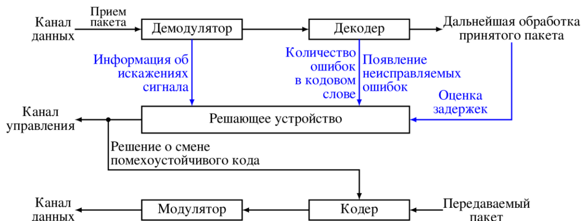
Рис. 1. Блок-схема приемопередатчика системы с адаптивным помехоустойчивым кодированием
