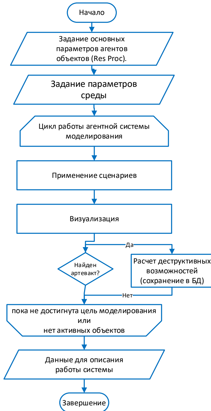
Рисунок 41 – Обобщенная блок-схема системы имитационного моделирования деструктивных возможностей ИТ-инфраструктуры РИС
