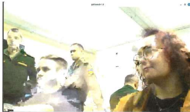
Рисунок 14 – Визуальное качество видеоизображения, полученного с использованием видеокодека H.264, при заданных параметрах сети
