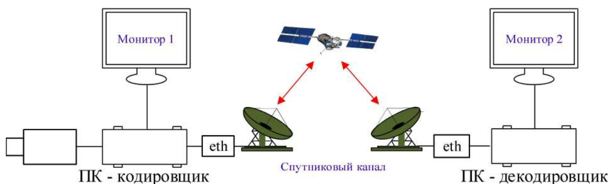
Рисунок 6.28– Схема испытательного стенда в режиме работы через станции спутниковой связи
