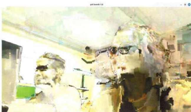
Рисунок 23 – Визуальное качество видеоизображения, полученного с использованием видеокодека H.265, при заданных параметрах сети
