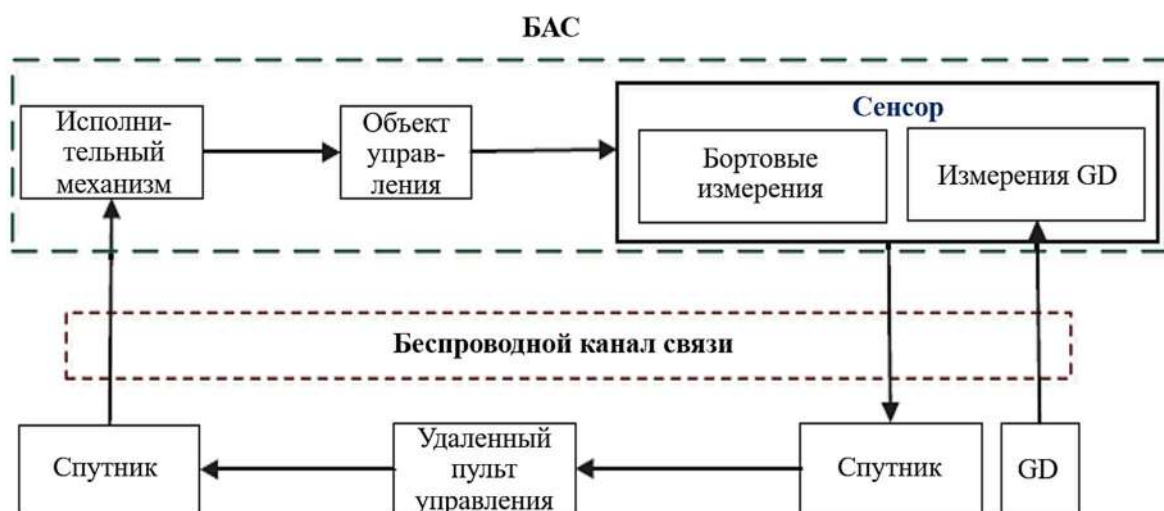
Рисунок 1.19 – Структура взаимодействия оператора и БАС
