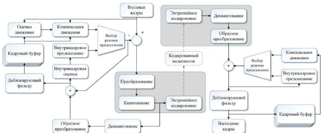
Рисунок 1.16 – Структура типичного кодера (слева) и декодера (справа)
