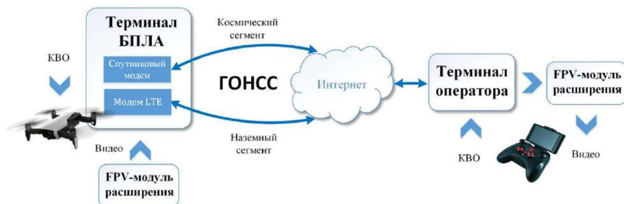
Рисунок 6.17 – Структурная схема ПАК
