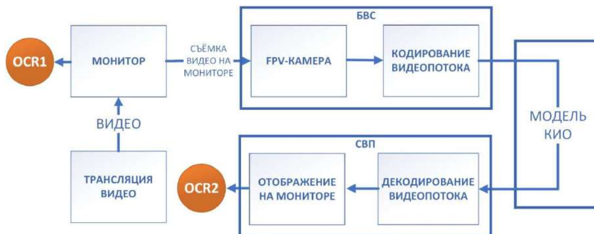
Рисунок 6.4 – Моменты времени измерения задержки передачи видеопотока
