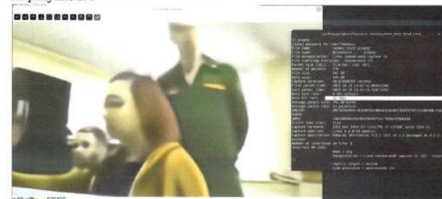
Рисунок 27 – Визуальное качество видеоизображения, полученного с использованием видеокодека NVC, и значение битрейта в режиме передачи видеопотока по низкоскоростному каналу спутниковой связи
