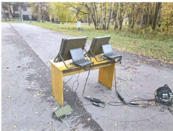
Рисунок 5 – Настройка станций спутниковой связи P-444-ПТН для проведения испытаний
