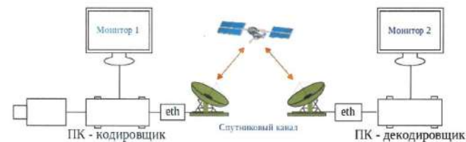
Рисунок 3 – Схема испытательного стенда в режиме работы через станции спутниковой связи
