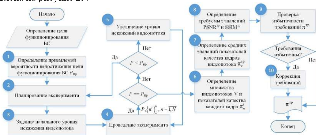
Рисунок 29 – Структурно-логическая схема подхода к обоснованию требований к перцептивному качеству восстановленного цифрового FPV-видеопотока
