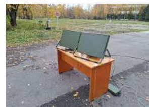
Рисунок 36 – Спутниковые терминалы «Р-444-ПТН»
