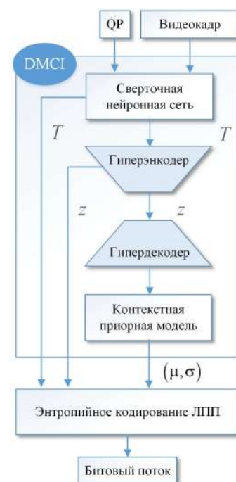
Рисунок 13 – Упрощённая схема работы НВК DMCI
