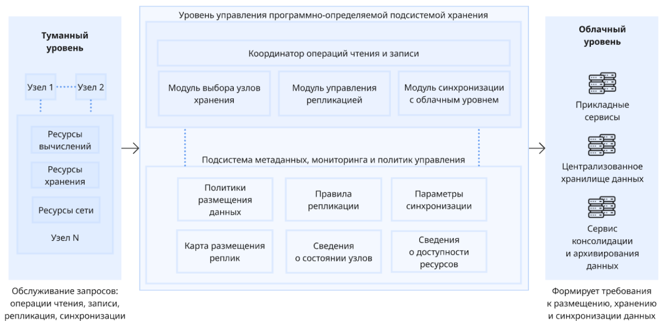
Рисунок 1.5 – Структурная схема взаимодействия с верхним уровнем хранения
