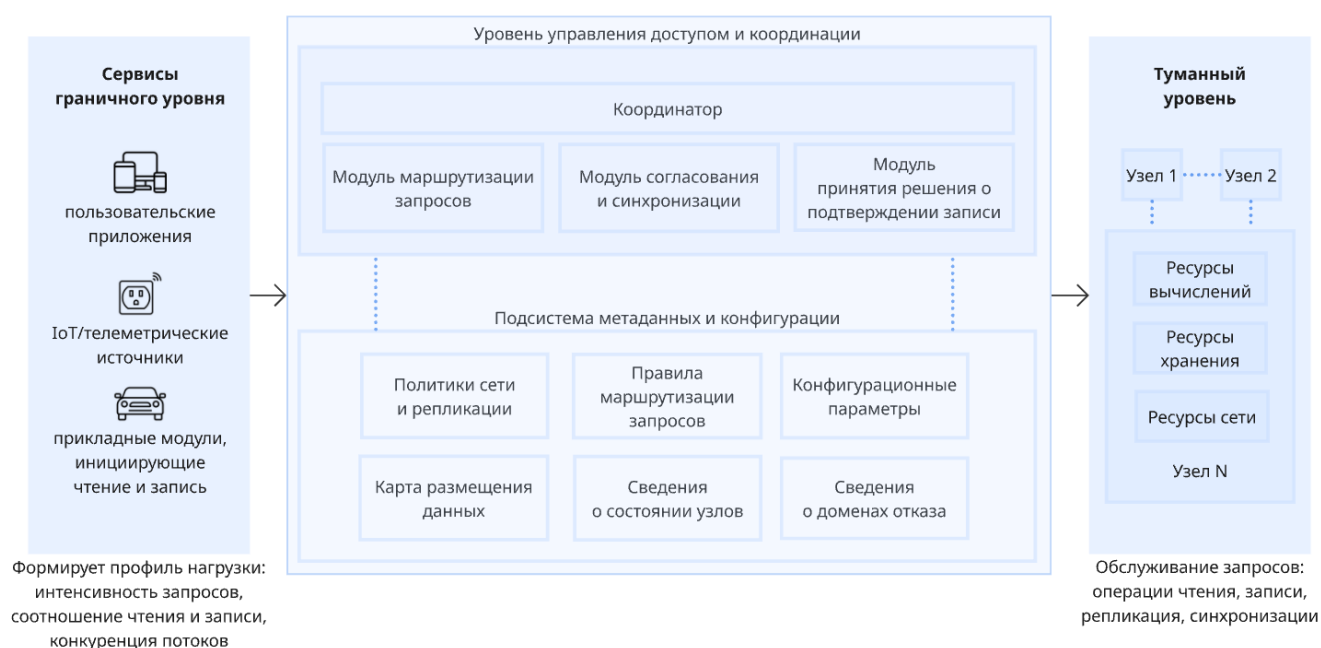
Рисунок 1.3 – Функциональная архитектура распределенной подсистемы хранения туманного уровня
