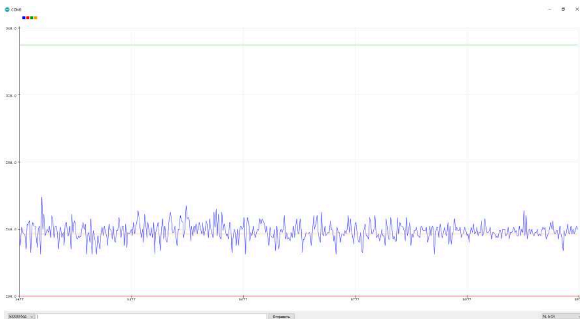
Рисунок 4.12 - Удержание датчика изгиба на одном положении для проверки постоянства результата.
