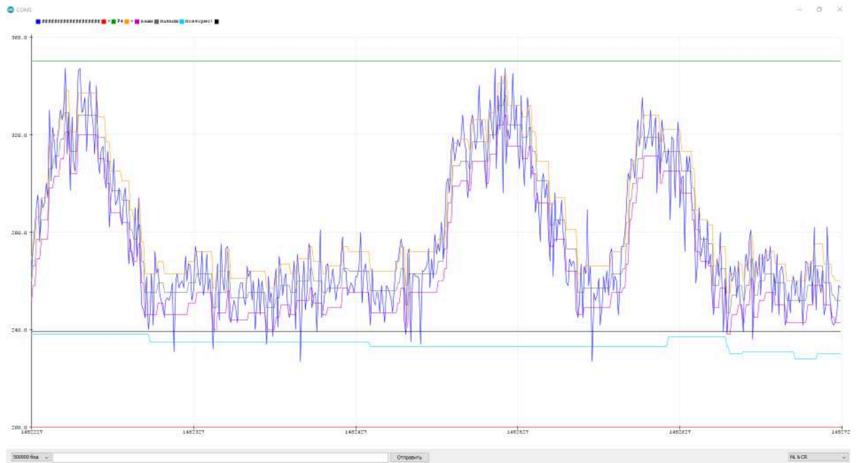
Рисунок 4.6 - Применение фильтра корректировки помех с коэффициентом 1.1
