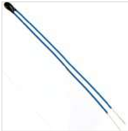
Рисунок 5.17 - Внешний вид используемого термистора
