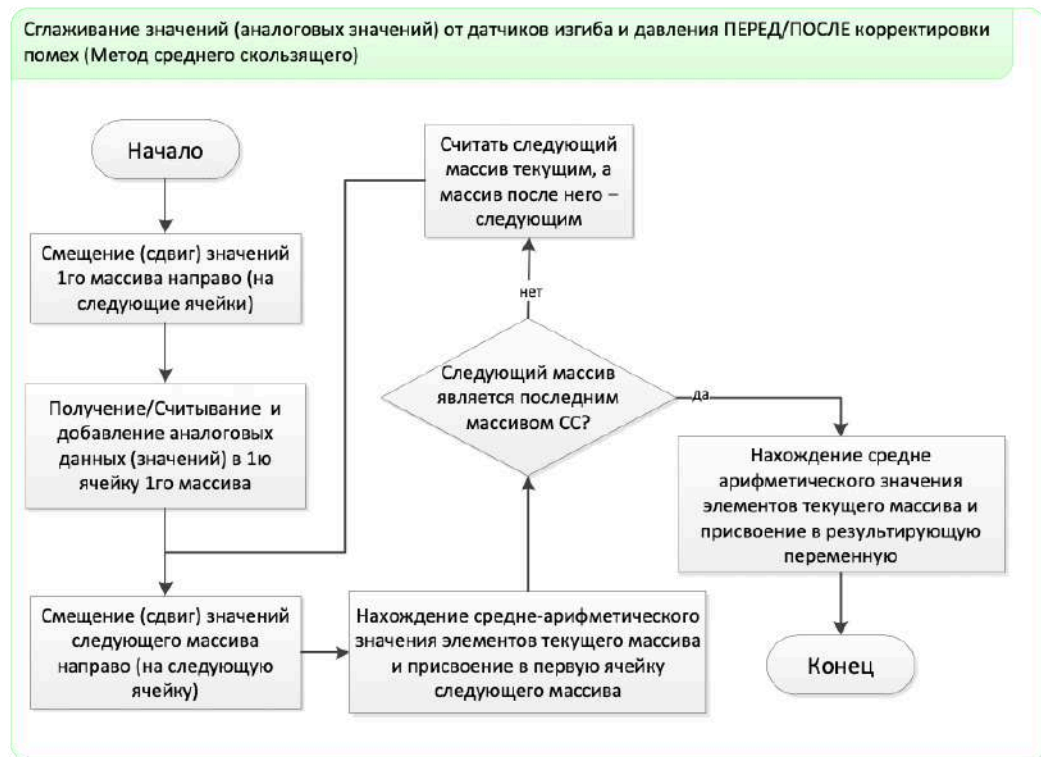
Рисунок 4.4 - Алгоритм разработанной версии среднего скользящего
