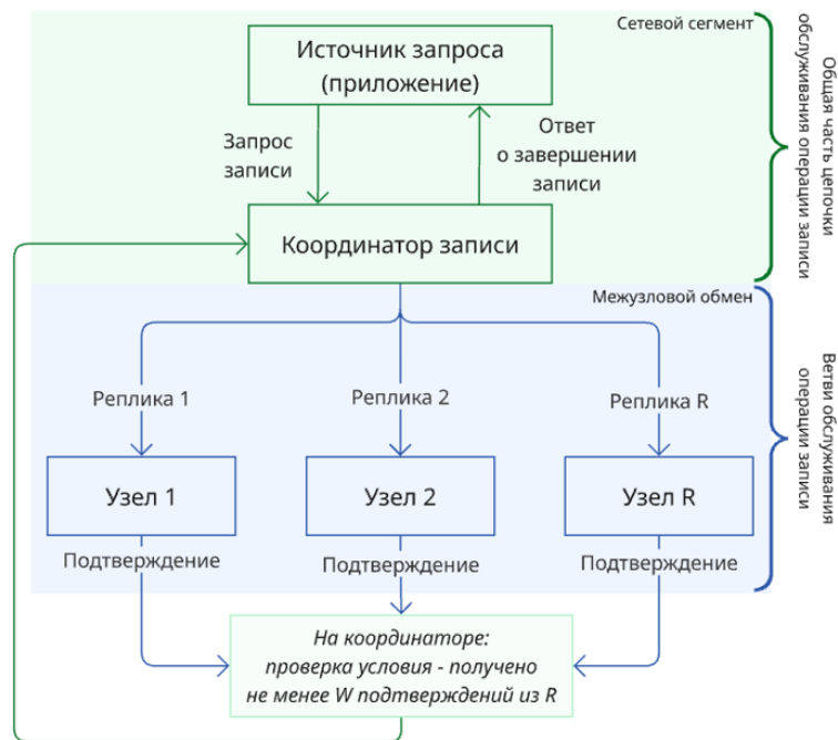
Рисунок 2 – Схема обслуживания операции записи с репликацией
