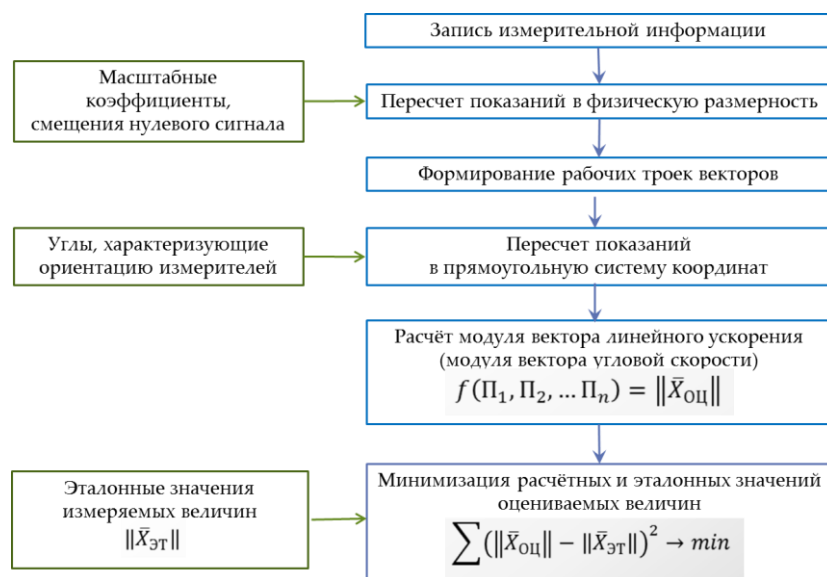
Рисунок 2.3 – Схема применения скалярного способа калибровки с использованием МПО
