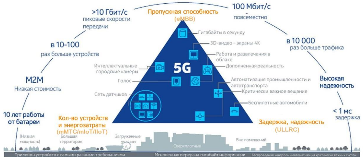
Рис.1.4 – Функциональные возможности, предлагаемые сетями 5G/IMT-2020
