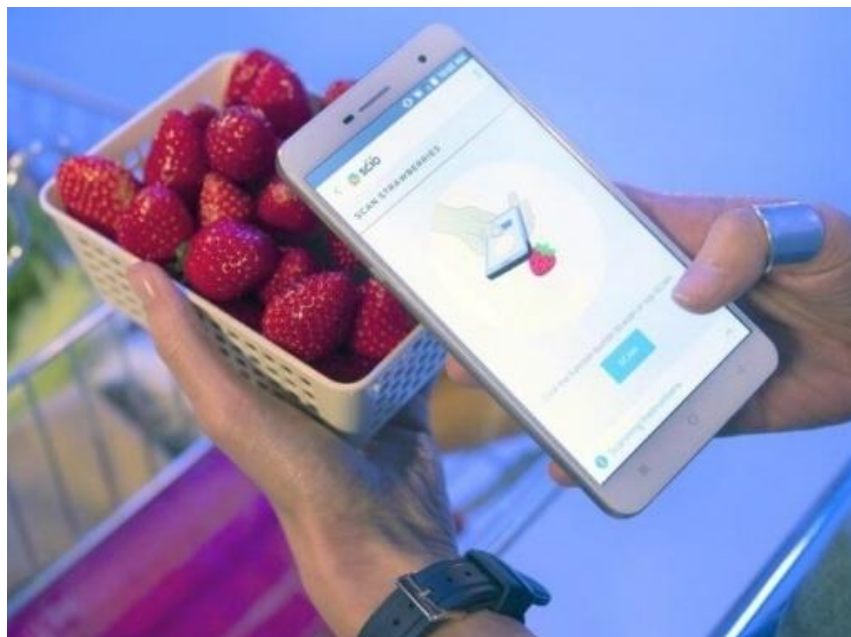
Рисунок 20 – Смартфон ChangHong H2 со встроенным инфракрасным микроспектрометром SCiO
