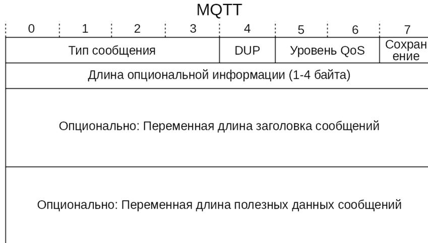
**Рис. 26.** Структура метаданных протокола MQTT
