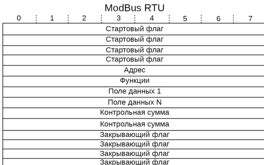
**Рис. 28.** Структура метаданных протокола ModBus RTU
