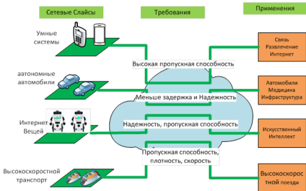
Рисунок 7 – Сетевые виртуальные функции в сетях связи 5G/IMT-2020 и соответствующие им требования для сетевых сегментов
