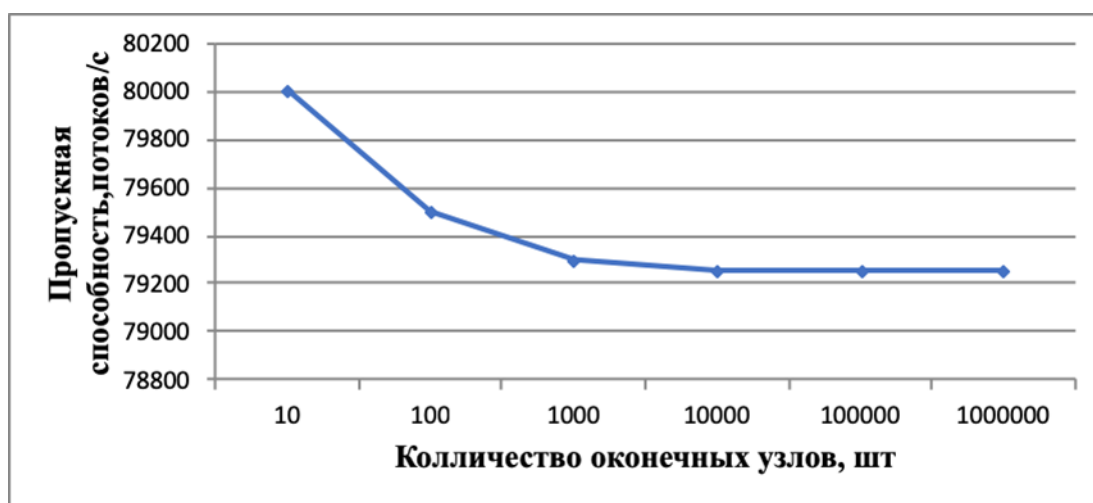
Рисунок 13 – Зависимость пропускной способности от числа оконечных узлов, при постоянном количестве коммутаторов
