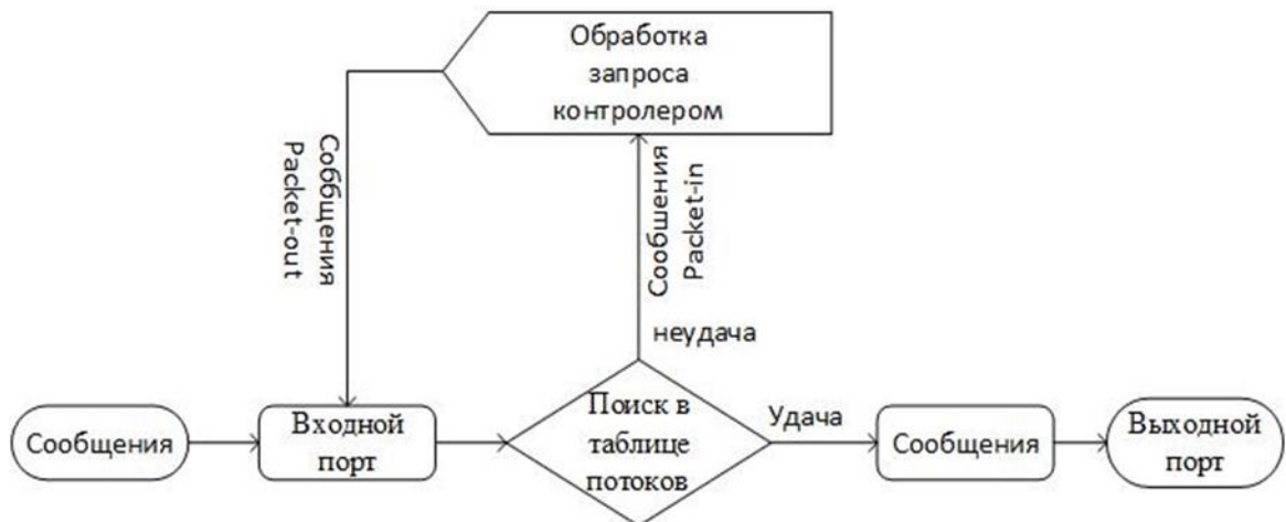
Рисунок 10 – Процесс передачи сообщения через OpenFlow коммутатор
