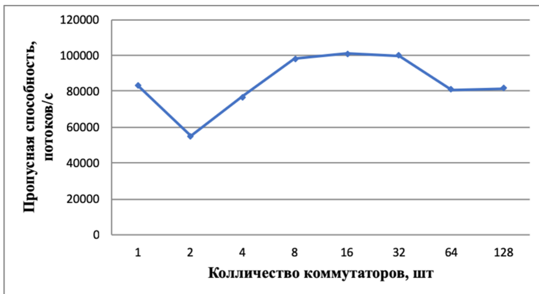
Рисунок 12 – Зависимость пропускной способности от числа коммутаторов, при постоянном количестве оконечных узлов (1000000)
