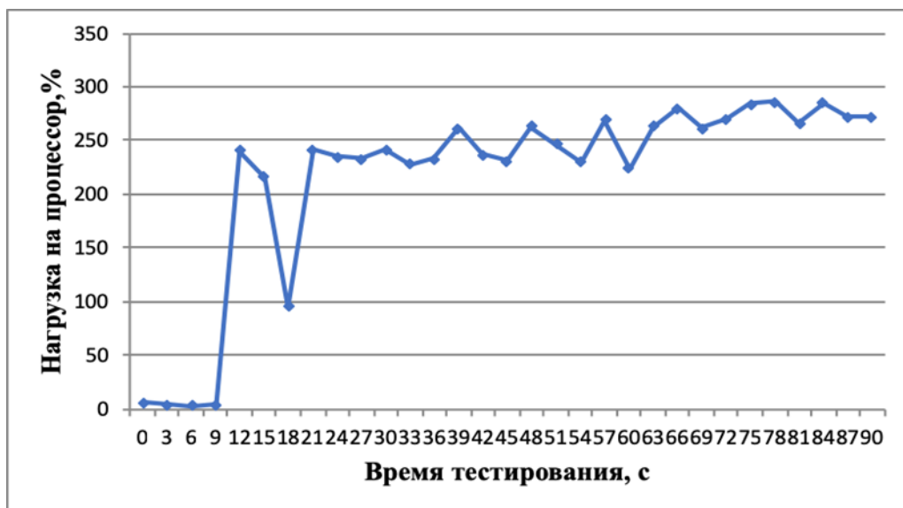
Рисунок 23 – Зависимость нагрузки на процессор от времени тестирования
