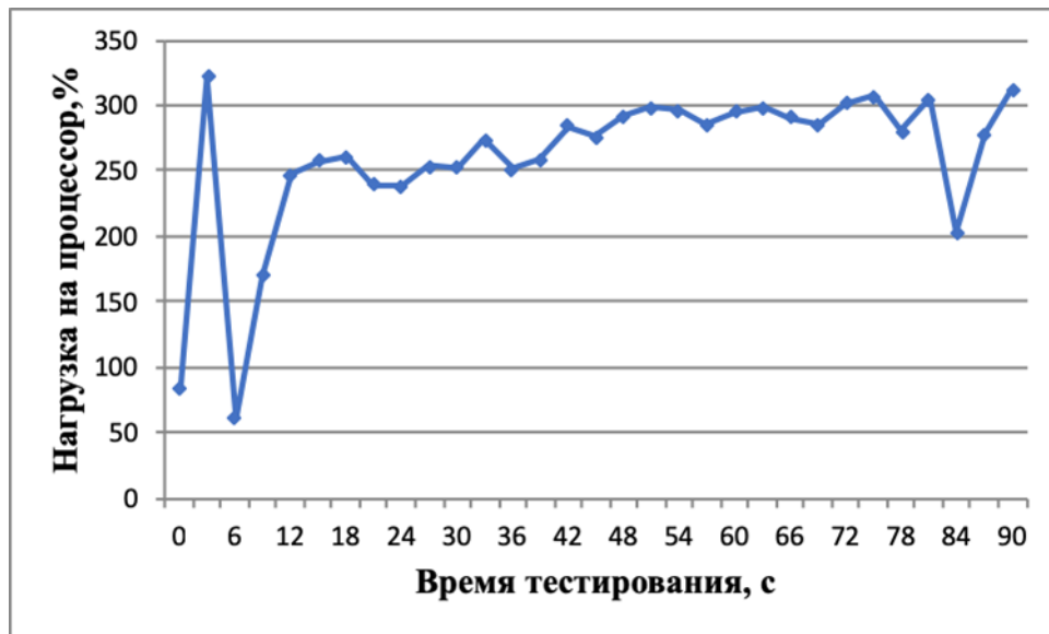
Рисунок 25 – Зависимость нагрузки на процессор от времени тестирования
