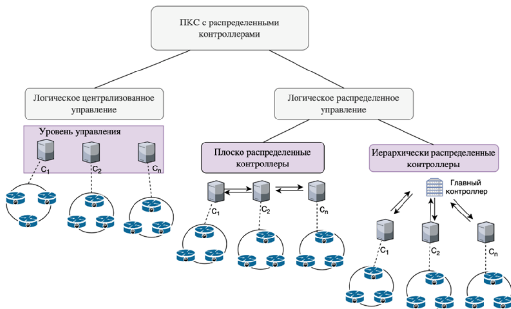
Рисунок 35 – Архитектура ПКС с физически распределенными контроллерами
