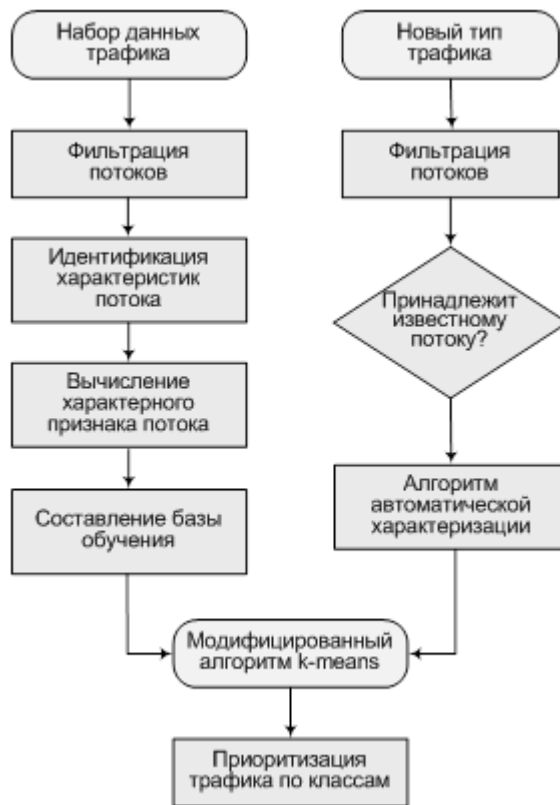
Рисунок 43 – Механизм классификации и приоритизации трафика
