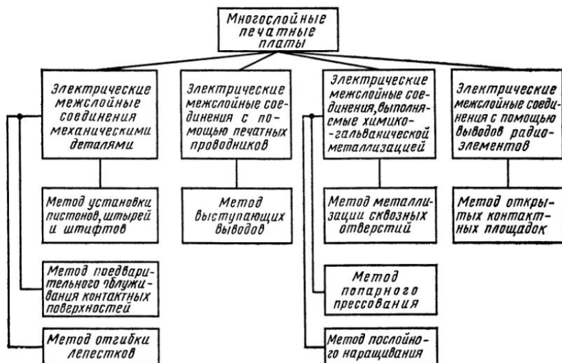
Рис 2.1 Классификация методов изготовления МПП
